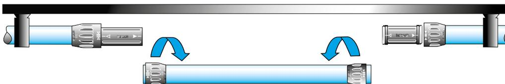
Pour faciliter l'ajout d'une descente ou d'un piquage supplémentaire, le système utilisé disposera d'une gamme de produits permettant de percer sous pression.
